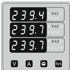
Ekran 3 : Napięcie jednej fazy (Układ 1F2P)
