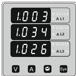
Ekran 4 : Prądy fazowe (Układ 3F4P i 3F3P)
